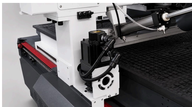
СЕРВО ЗАДВИЖВАНЕ, РЕДУКТОР И КОСОЗЪБА РЕЙКА НА ОС X
