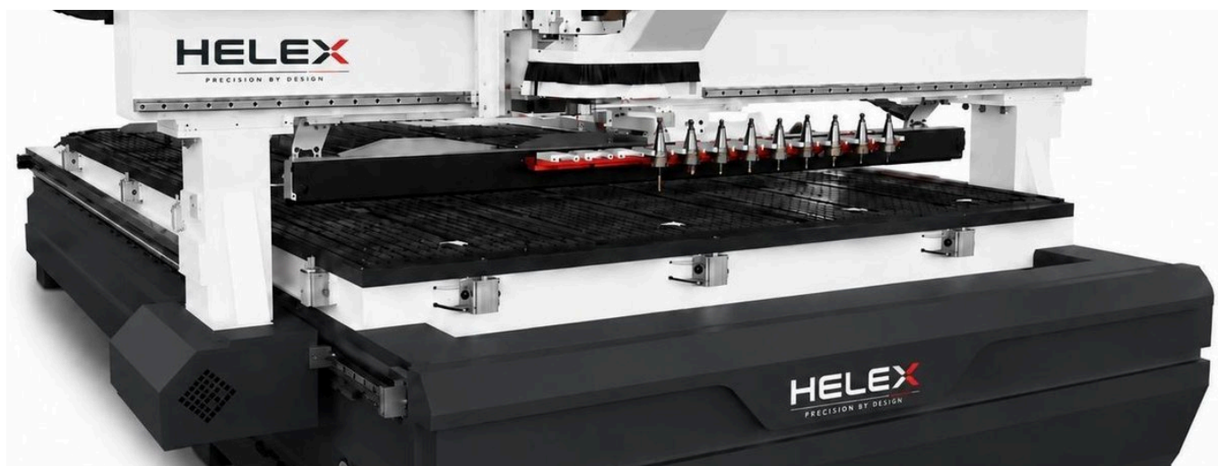
СТРУКТУРА НА ПОРТАЛА, ВАКУУМНА МАСА И ЛИНЕЕН ИНСТРУМЕНТАЛЕН МАГАЗИН
