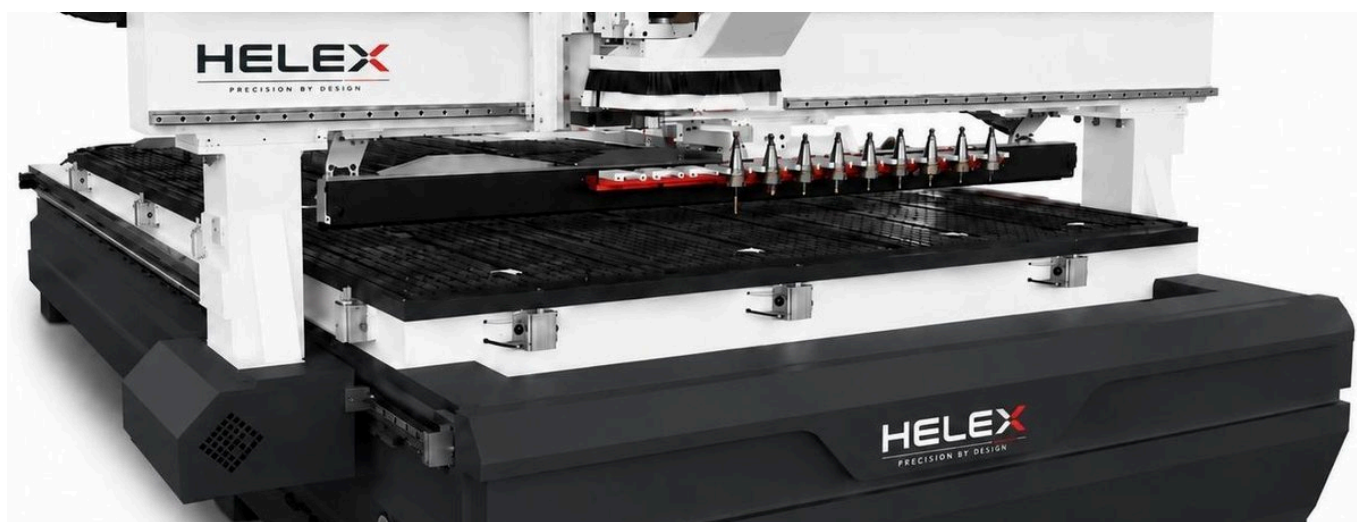
STRUCTURA PORTALULUI, MASA CU VACUUM ȘI MAGAZIA LINIARĂ DE SCULE
