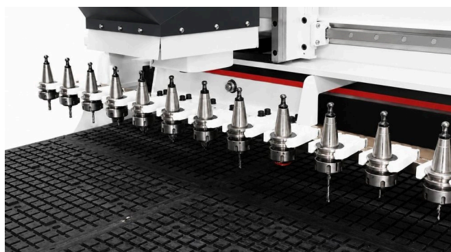
PORT-SCULE ISO30 ÎN MAGAZIE, PREGĂTITE PENTRU SCHIMBARE AUTOMATĂ
