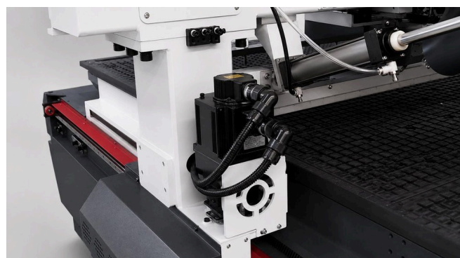
SERVOACȚIONARE, REDUCTOR ȘI CREMALIERĂ ELICOIDALĂ PE AXA X
